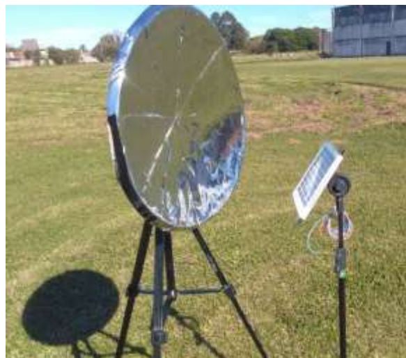
Fotografia 2: Posição da antena e placa durante os testes
