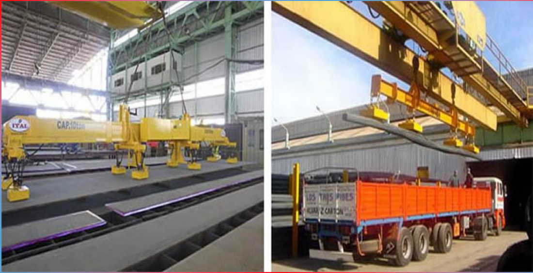
Figura 24 - Eletroímã usado na indústria.
